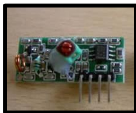
Figura 07. Módulos de RF receptor
