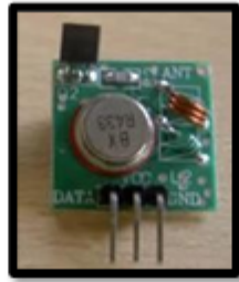
Figura 04. Módulos de RF emisor Fuente. Creación propia
